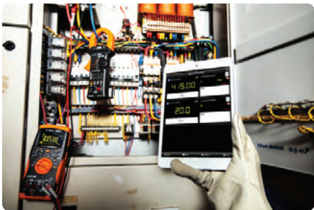
图 2. 通过 iOS/ 安卓系统智能设备远程监测手持式万用表和钳形表的读数
