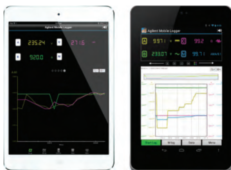
图 11. 使用 Agilent Mobile Logger 应用软件记录数据
