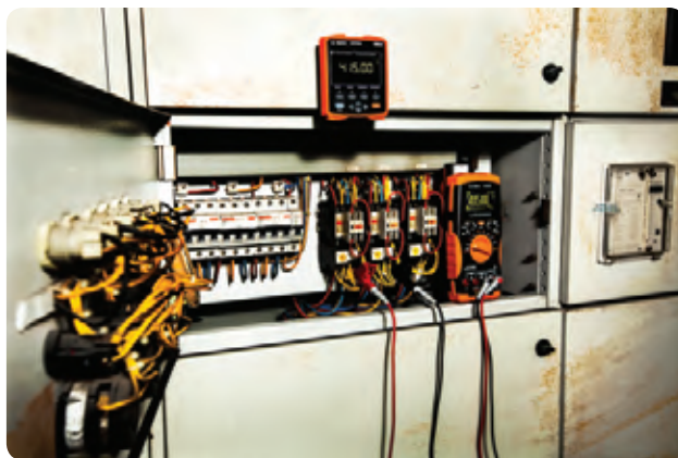
图 3. 通过 U1115A 远程显示屏监测手持式仪表的读数
