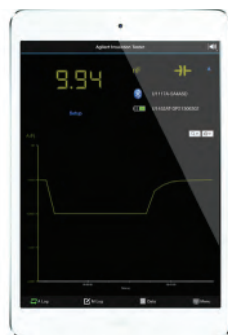
图 13. Agilent Insulation Tester 应用软件上的数据记录界面
