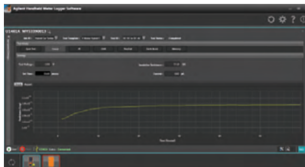
图 15. 在 Windows PC 上查看绝缘电阻测试趋势并生成测试报告
