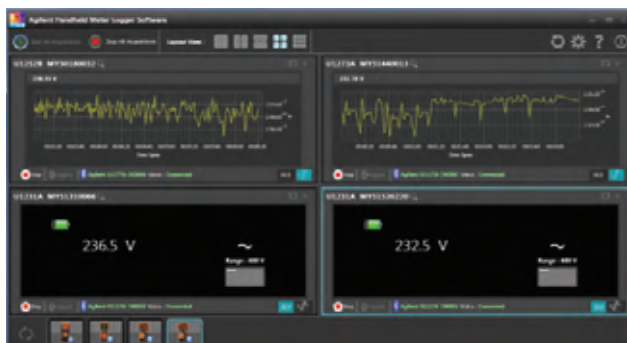
图 14. 使用 Agilent Handheld Meter Logger 软件查看多达 10 个手持式仪表的读数
