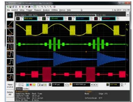
圖 7：高達 20 GHz 的 4 個不同脈衝信號
