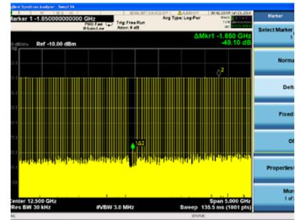
圖 6：10 GHz 至 15 GHz 多音頻信號
