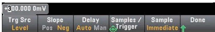
図5. Truevolt DMMの高度なトリガモードでは、レベルトリガの設定が可能です。
