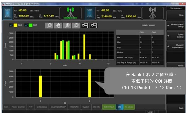
圖 11：圖中顯示 CSI 的子測試 3。Rank 中的振盪產生了一幅奇怪的 CQI 直方圖。回報為 Rank 2 時，會出現各種的 CQI 結果。當雜訊底線相近時，兩種字碼的 CQI 結果大致相似。回報為 Rank 1 時，單碼字 CQI 值通常會高一點；這個直方圖是 CQI 10-13。基本上，10 dB 的低 SNR 會造成 Rank 2 的 CQI 降低，並頻繁轉換到 Rank 1。切換 Rank 會導致資料傳輸速率大幅波動，因此 UE 建議使用一個或兩個碼字 / 串流。
