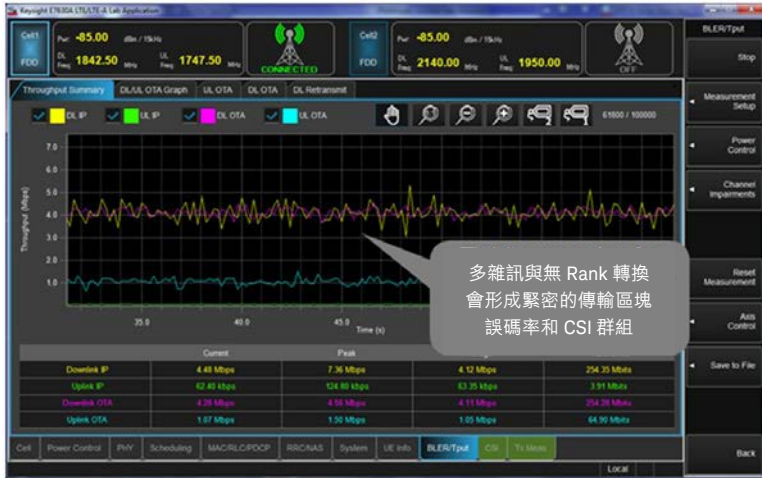
圖 12：圖中顯示在 10 MHz (ETU70 · 0 dB SNR) 上，子測試 4 使用 UXM 執行 TR 37.901 傳輸速率 / BLER 量測的實際結果。ETU70 會導致高度可變的 CQI，但是當 SNR 為 0 dB 時，其傳輸速率非常低。
