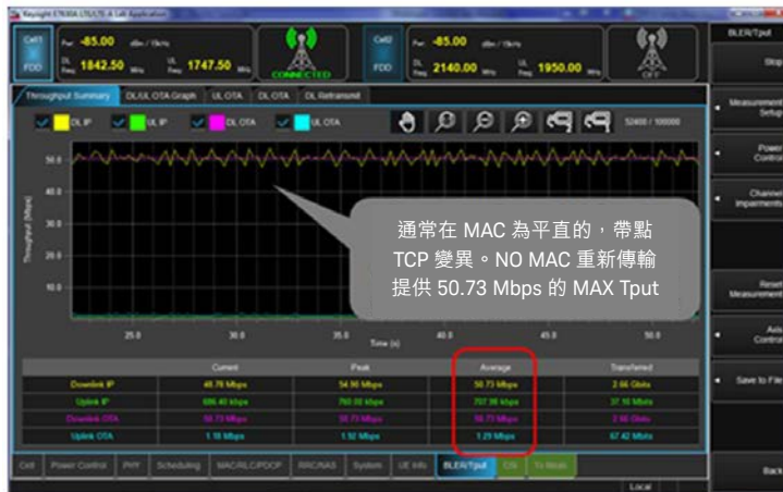
圖 6：此處顯示在 10 MHz (靜止，無雜訊)，子測試 1 使用 UXM 進行傳輸速率 / 傳輸區塊誤碼率 (BLER) 量測的結果。依據 TR 37.901 測試條件，10 MHz 的最大傳輸速率為 50.73 Mbps。
