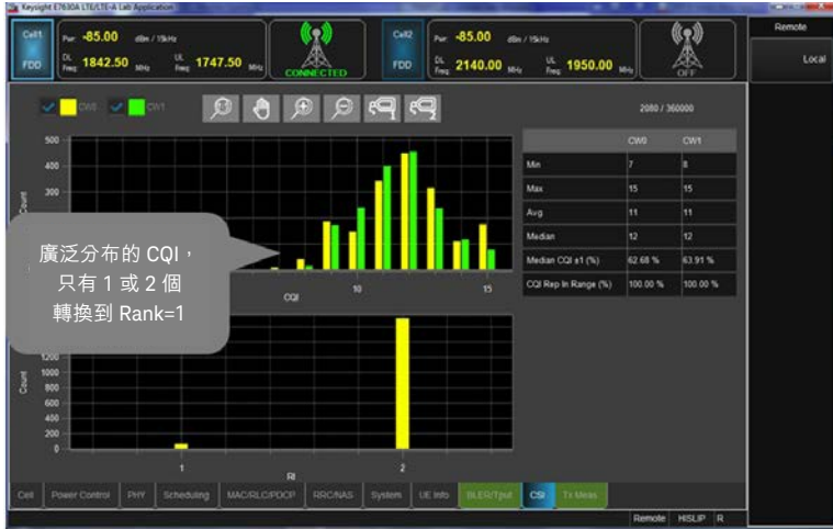
圖 9：圖中顯示 CSI 的子測試 2。注意：高度可變的大範圍衰減 EPA5 會產生各種不同的 CQI 結果，在信噪比僅 20 dB 時，大部分時間將限制於 Rank 2。
