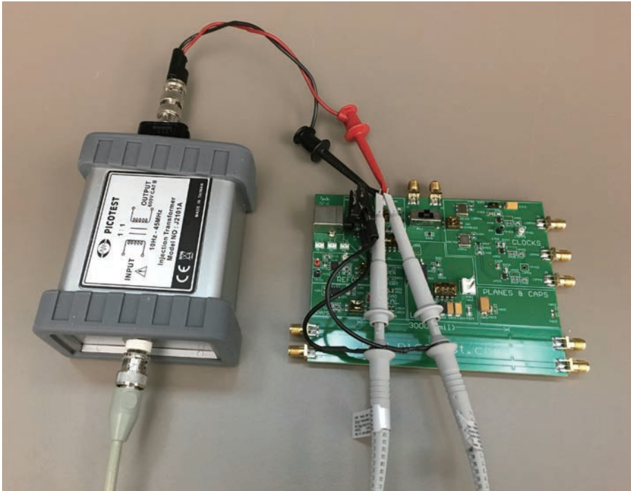
图 4: 环路响应测试隔离变压器和1:1无源探头的配置
