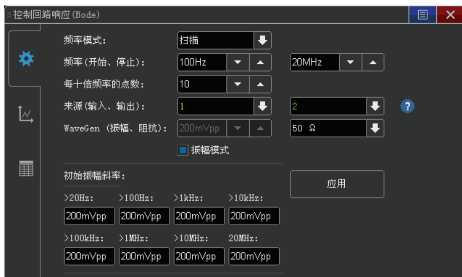
图 7: 利用幅度配置优化信噪比
