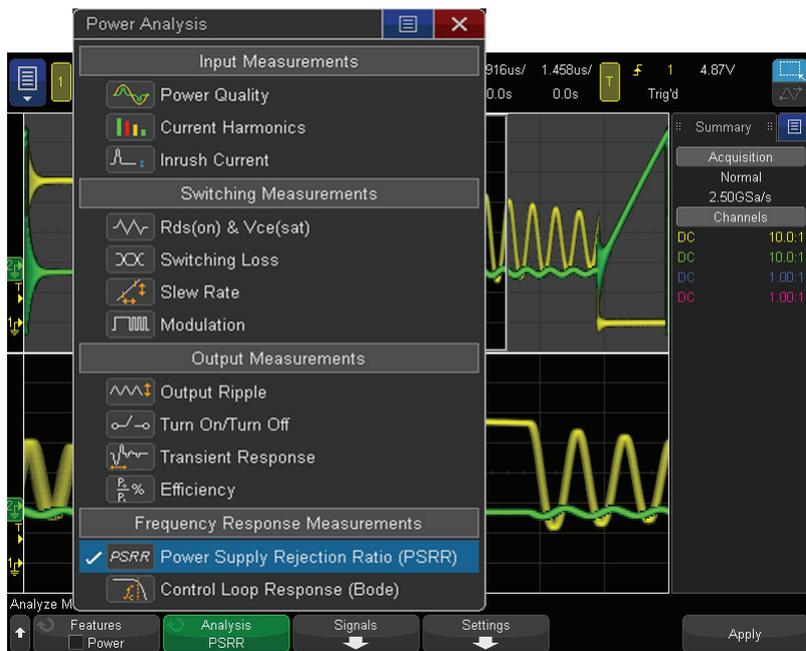
图 1: Keysight InfiniiVision X 系列示波器提供的电源表征测量。
