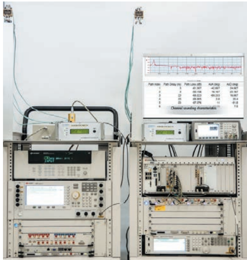
圖 8：該範例部署顯示在 28 GHz 載頻和 1 GHz 分析頻寬下的 4x4 MIMO 量測。它可進一步擴充為 44 GHz 載頻和 1 GHz 頻寬下的 8x8 MIMO。
