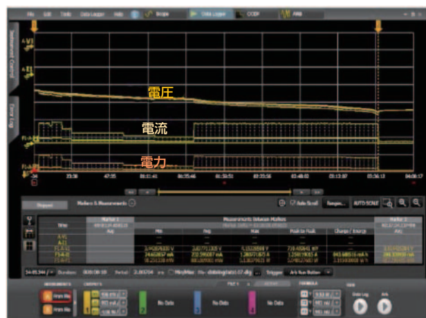
図4. バッテリーのランダウンテストの結果
