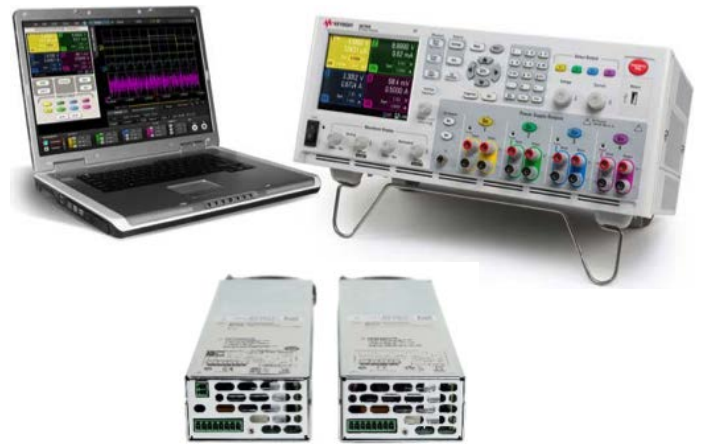
圖 3：Keysight N6781A 和 N6785A 電池耗電分析儀是二象限電源源量測設備（SMU）模組，可插入 N6705B 直流電源分析儀主機，而 14585A 控制和分析軟體是對電池供電醫療裝置進行電池放電測試的統合式解決方案
