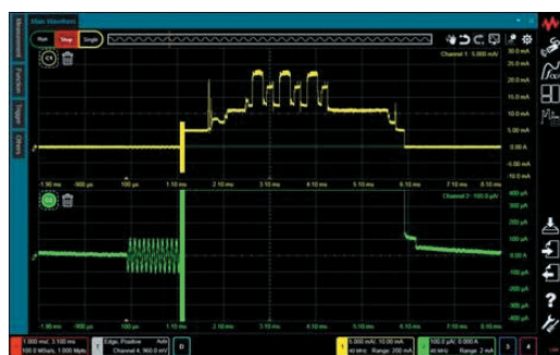
図5. CX1102A デュアルチャンネル電流センサによる広いダイナミックレンジの測定
