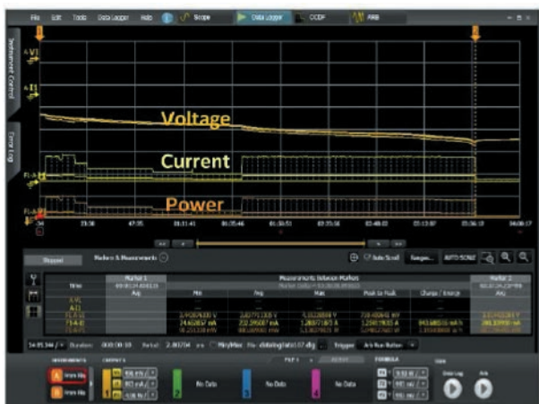
図3. バッテリーのランダウンテストの結果
