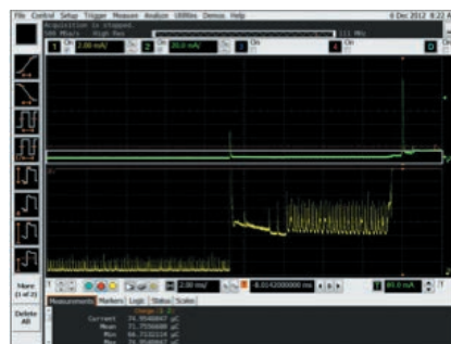
図7. InfiniiumオシロスコープとN2820A電流プローブを組み合わせると、曲線下の面積(電荷)を測定でき、正確な電流消費測定が行えます。
