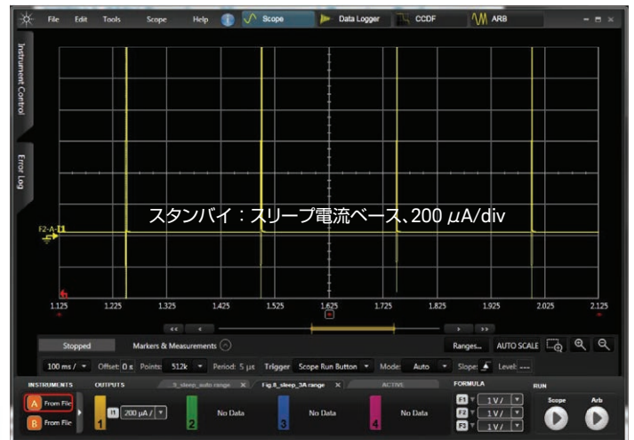
図3. Blipワイヤレス血圧計のスリープモード電流の測定結果。SMUは、1 mAレンジの精度(100 nAのオフセット誤差)で、 \mu Aレベルの測定から最高3 Aまでの測定が可能です。波形の各ポイントを最高の精度レベルで測定できます。従来のDMMとは異なり、この新しいソリューションでは、ダイナミックなパワー過渡現象を正確に測定できるので、バッテリー寿命への影響をより深く理解できます。
