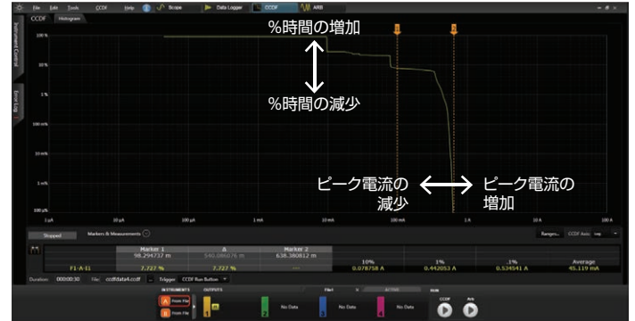
図5. 相補累積分布関数：1) スリープモードの電流、2) 電流計算結果の表示、3) 血圧計の測定電流、4) 血圧計のカフポンプのピーク電流。マーカーからは、データログレコードの7.7%が100 mA以上消費したことがわかります。
