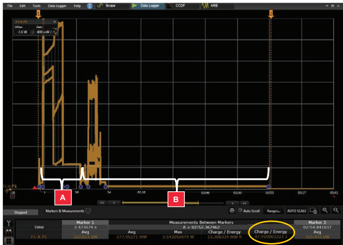
図4. Blipのエネルギードレインの詳細なプロフィールです。測定全体のエネルギー要件は47.9 Jで、所要時間は2.52分です。 [A]は測定全体のエネルギー使用量=34.7 Jで、[B]はWi-Fi転送+タイムアウトのエネルギー使用量=13.07 Jです。
