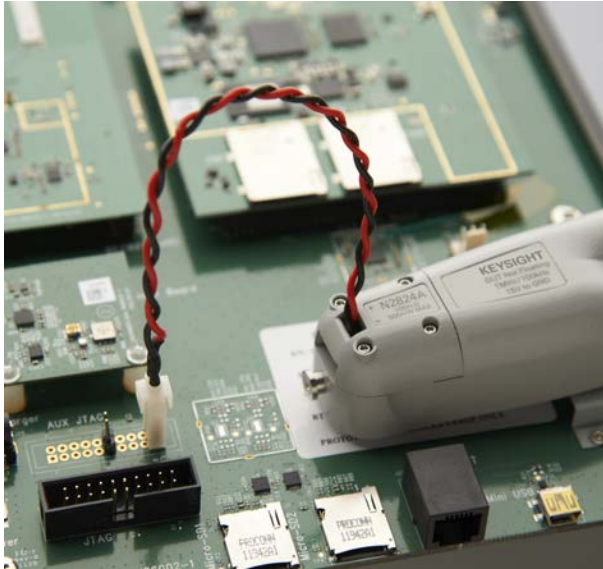
圖 6：Keysight N2824A 連接至 PCBA
