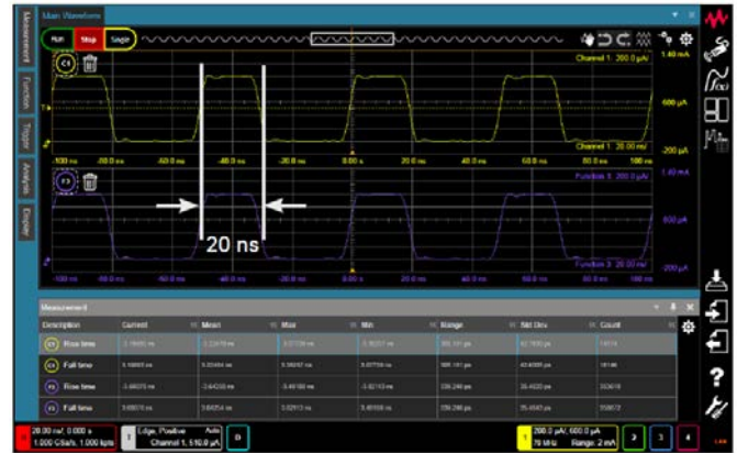
圖 16：Keysight CX3300 清楚顯示 20-ns 的脈衝
