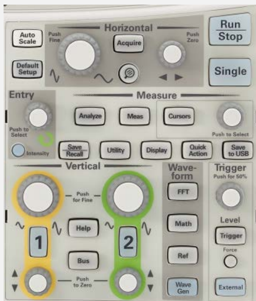
図2. オシロスコープのフロントパネルには、重要なセットアップ変数に対応するノブがあります。
