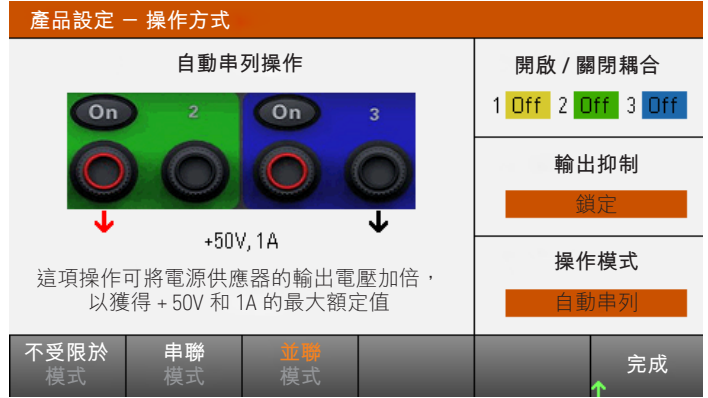
圖 3：自動串聯操作可將輸出電壓加倍
