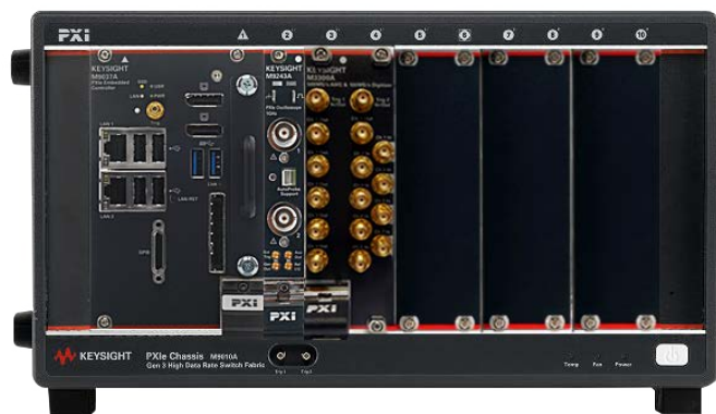
PXIオシロスコープと高速デジタイザを組み合わせた、 多チャンネル高速データ収録&後解析環境
