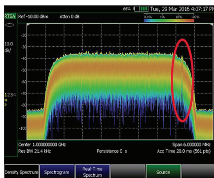
图 5. RTSA 能够以“密度显示”模式显示测量结果，在指定的频率扫宽上提供信号命中功能。此功能使其能够利用独特的统计功能，更容易地识别含有功率电平波动的两个不同信号。此屏幕快照显示了 RTSA 如何快速清晰地看到“威胁”。
