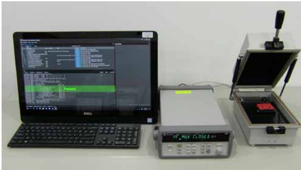
X8711A 包含 34972A 資料擷取裝置、34999A 射頻模組，和基於是德科技自動測試平台的量測套件、KS83301A BLE 4.2 信號及 KS83302A WLAN b/g/n 信號。使用者需提供系統 PC、隔離箱及射頻纜線。
