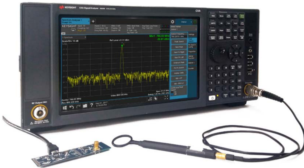
圖 2：您需在設計周期中，使用近場探棒和 CXA 信號分析儀，測試 PC LAN 埠之雜訊，然後才進行完整的相符性測試
