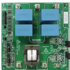
図4 SiC MOSFET搭載の評価ボード
