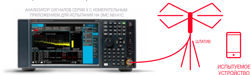
Рисунок 4. Схема измерения уровня собственных электромагнитных излучений устройства
