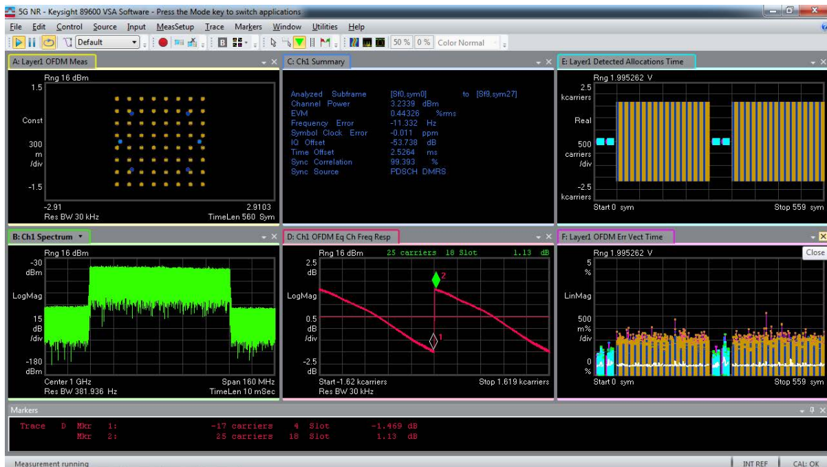
図2.1：内部チャネル補正をオフにした5G NR信号の測定
