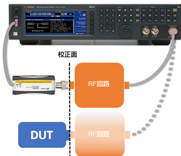
図2.3：USBパワーセンサを使用したユーザーチャンネル補正校正の実行
