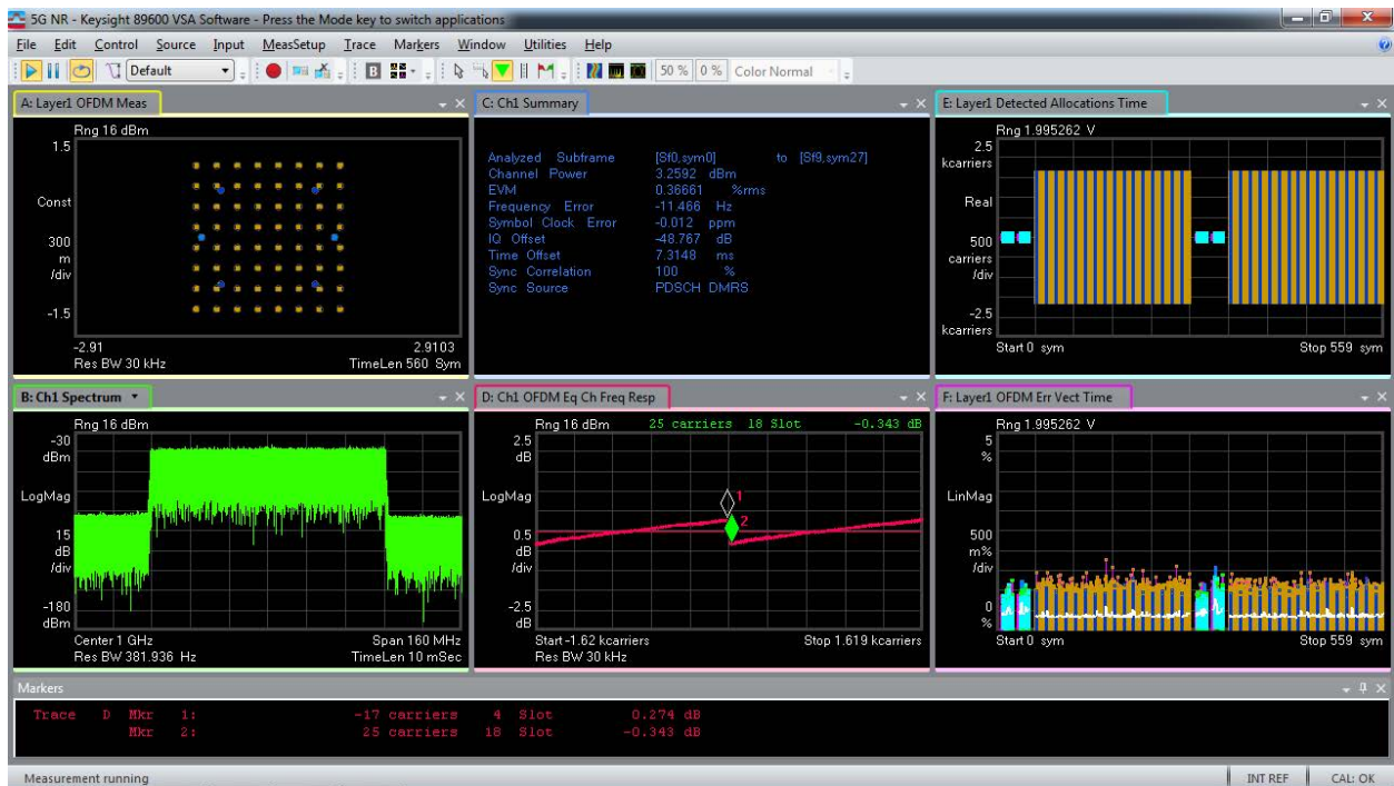
図2.2：内部チャンネル補正をオンにした5G NR信号の測定
